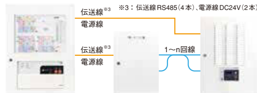
火災・複合火災受信機 P型インターフェイス盤 FXZJ004シリーズ 表示機(部屋番号表示付) FIPJ104シリーズ
